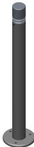
Potelet sur platine peint thermolaqué, coloris au choix nous consulter. Corps en tube acier de diamètre 76 mm. Tête en fonte d'aluminium. Platine en tôle acier ep. 15mm et de diamètre 18 cm. Dim (cm) : H 120, poids 8 kg.
