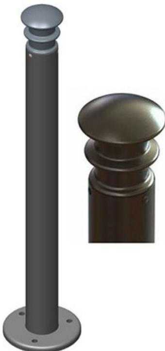
Potelet sur platine peint thermolaqué, coloris au choix nous consulter. Corps en tube acier de diamètre 76 mm. Tête en fonte d'aluminium. Platine en tôle acier ep. 15mm et de diamètre 18 cm. Dim (cm) : H 90, poids 6,5 kg.
