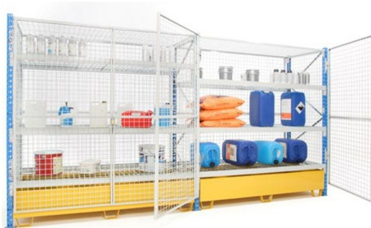
Bac de rétention 375 L à poser au sol, pour rayonnage grillagé semi lourds profondeur 80 cm. Fabriqué en tôle ép. 2 mm, manutentionnable. Finition peinture époxy jaune RAL 1004. Dims (cm) : L177,5 X P80 X H26.
