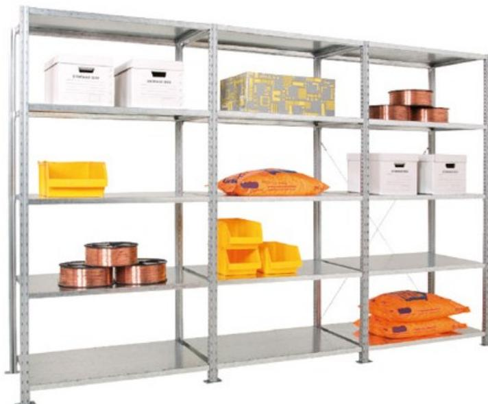
Poteau : Profil «T» 40x37mm sans perforation en façade perforé latéralement au pas de 40 mm. Pied plastique. Tablette : Entièrement démontable, s'enclenche directement dans les perforations latérales des montants.
