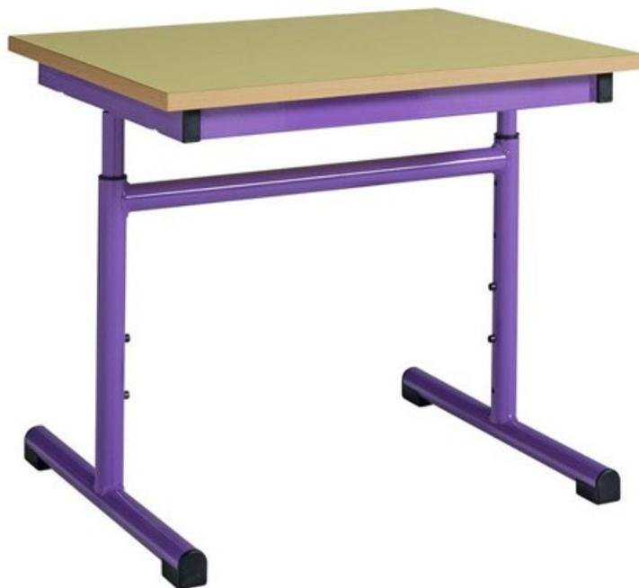
Structure à dégagement latéral. Piétement tube diamètre 32 mm pour le montant bas et l'embase, tube diamètre 25 mm pour le montant haut. Traverse de renfort tube diamètre. 32 mm. Structure sous plateau tube 40 X 20 ép. 1.5 mm. Système de réglage sur 2 points, un taquet de positionnement sur ressort et un boulon de blocage. Soudures avec apport de matière. Patins en PVC noir non tachant. Finition piétement : poudre époxy (plusieurs finitions possibles).
