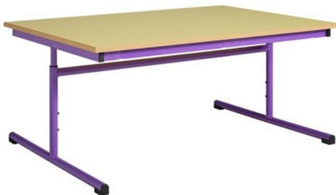
Structure à dégagement latéral. Piétement tube diamètre 32 mm pour le montant bas et l'embase, tube diamètre 25 mm pour le montant haut. Traverse de renfort tube diamètre. 32 mm. Structure sous plateau tube 40 X 20 ép. 1.5 mm. Système de réglage sur 2 points, un taquet de positionnement sur ressort et un boulon de blocage. Soudures avec apport de matière. Patins en PVC noir non tachant. Finition piétement : poudre époxy (plusieurs finitions possibles).
