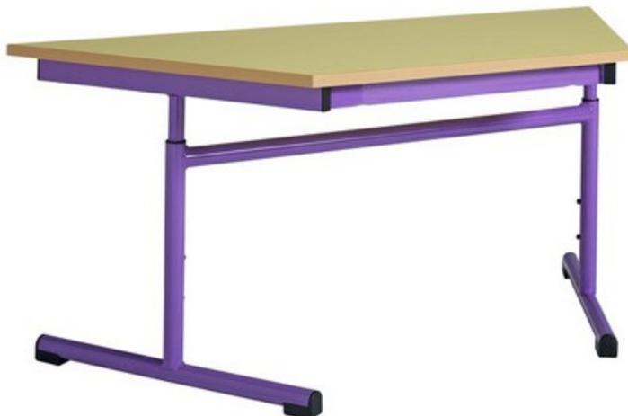
Structure à dégagement latéral. Piétement tube diamètre 32 mm pour le montant bas et l'embase, tube diamètre 25 mm pour le montant haut. Traverse de renfort tube diamètre. 32 mm. Structure sous plateau tube 40 X 20 ép. 1.5 mm. Système de réglage sur 2 points, un taquet de positionnement sur ressort et un boulon de blocage. Soudures avec apport de matière. Patins en PVC noir non tachant. Finition piétement : poudre époxy (plusieurs finitions possibles).
