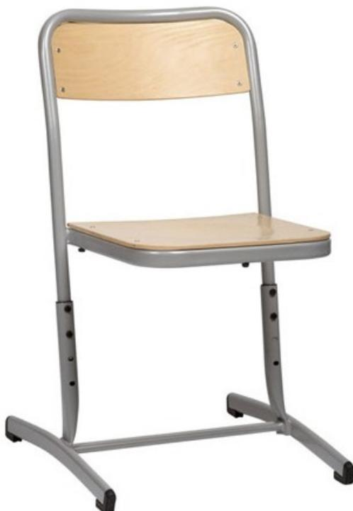
Structure tube diamètre 25 mm. Ossature sous l'assise et traverse de renfort en partie basse méplat chants ronds 30 X 15 mm. Embase cintrée tube méplat chants ronds 36 X 18 mm. Finition peinture époxy, plusieurs coloris au choix. Patins en polypropylène noir non tachant. Assise en applique et dossier encastré en hêtre multiplis ép. 8 mm, finition verni naturel. Patins en caoutchouc non tachant sous le cadre de l'assise. Version réglable de 4 à 6. Garantie 10 ans.
