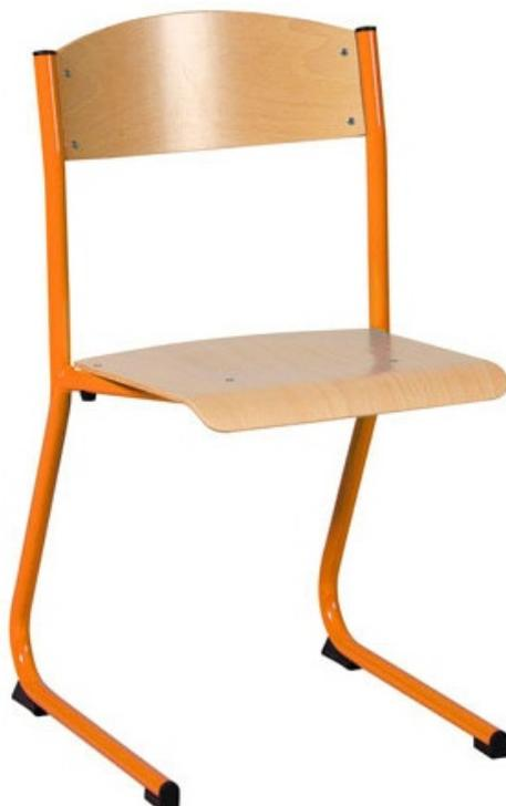
Tailles 7. Piétement monobloc en tube diamètre 25 X ép. 1,5 mm. Renfort sous l'assise. Soudures avec apport de matière. Finition peinture époxy, plusieurs coloris au choix. Patins en polypropylène noir non tachant. Assise et dossier en hêtre multiplis ép.8 mm, finition verni naturel. Garantie 10 ans.
