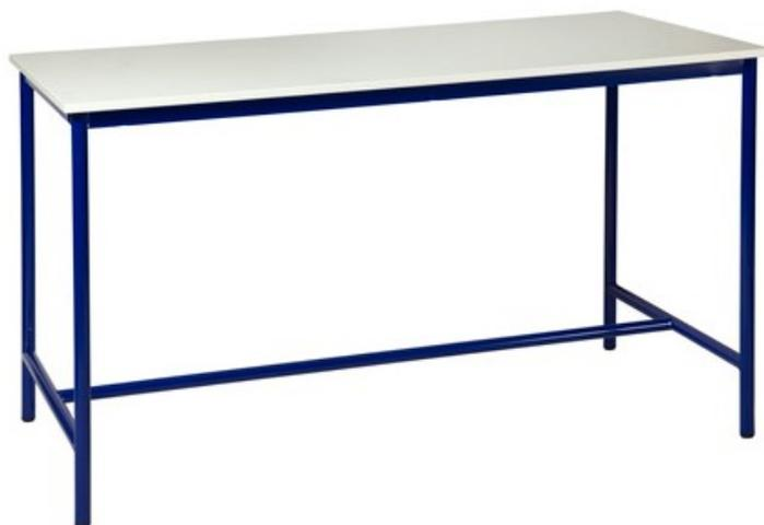
Structure métallique monobloc tube diamètre 32 mm. Piétement entretoisé tube diamètre 32 mm. Finition peinture époxy, plusieurs coloris au choix. Plateau stratifié chant ABS : panneau de particule ép. 19 mm, recouvert de stratifié haute pression 8 10ème sur les deux faces. Epaisseur totale 22 mm. Chant ABS ép. 2 mm collé à chaud en applique sur le panneau. Hauteur 90 cm. Livrées montées.
