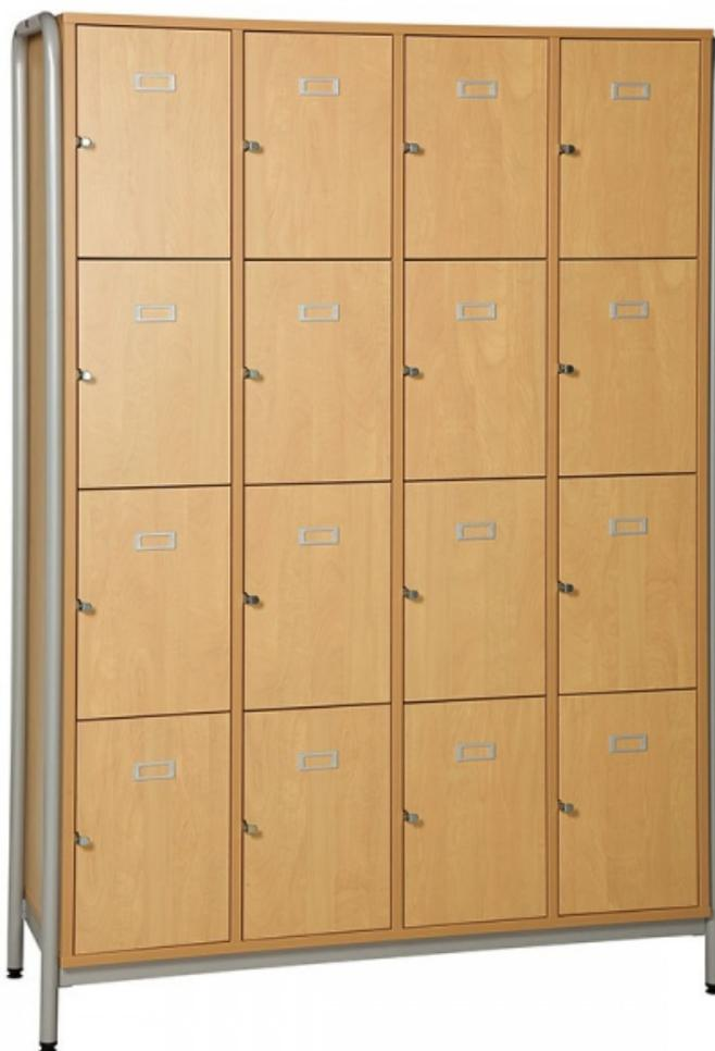
Structure en mélaminé ép. 19 mm. Chants ABS ép. 2 mm. Portes encastrées avec charnières invisibles à ouverture à 90 degrés et porte étiquette. Fermeture par morillon porte cadenas. Piètement acier. L X H X P hors tout 1200 X 1830 X 450 mm. L X H X P d'une case utile : 272 X 395 X 410. Plusieurs coloris de panneaux et de piètement au choix, nous consulter.
