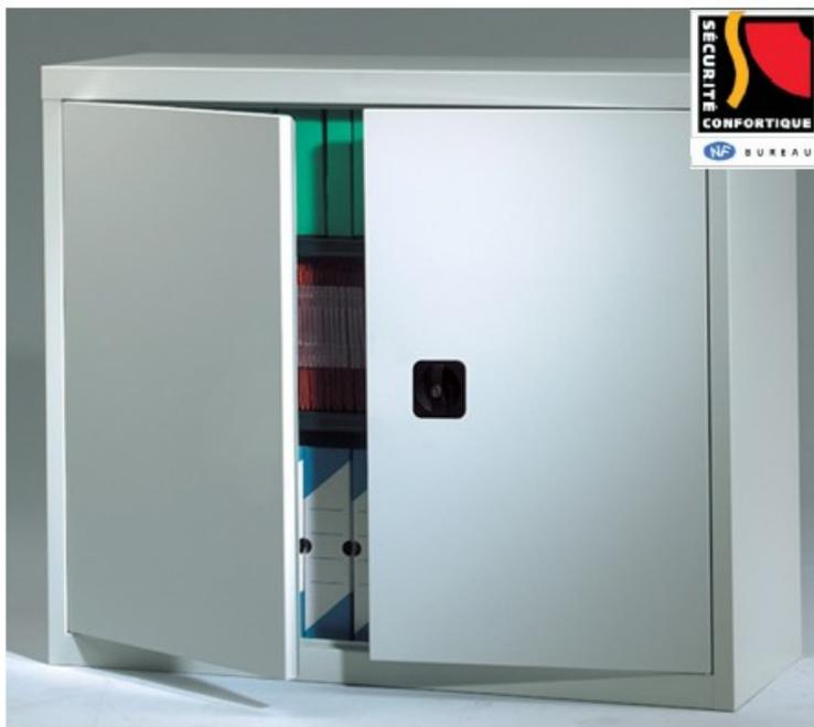
Corps composé de 2 côtés, 2 doublures intérieures, 1 dos en une seule partie, 1 dessous intégrant la plinthe, 1 dessus, 1 plinthe, en tôle d'acier de 1er choix épaisseur 8,10e.
