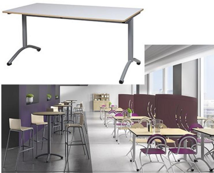
Table livrée montée. Tailles de 1 à 6. Garantie 10 ans. Table à dégagement latéral : piétement monobloc, montants diamètre 60 mm et embases diamètre 40 mm. Structure sous plateau en tube 30 x 30 mm et traverse 50 x 20 mm. Vérins et embouts de réglage en polyéthylène noir non tachant. Plateau stratifié épaisseur 22 mm. Chants surmoulés : Résine polyuréthane noire injectée à chaud dans un moule pour recouvrir le bord du plateau. Plusieurs coloris de plateaux et de piétement au choix.
