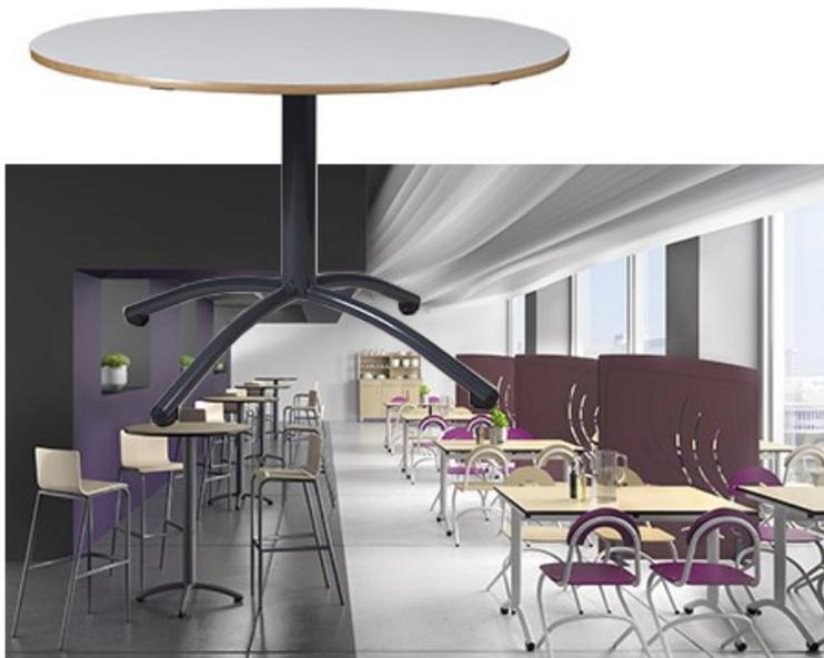
Tailles de 1 à 6. Garantie 10 ans. Table à piètement central : piètement central monobloc. Structure sous plateau en tube 30 x 30 mm avec platine de renfort ép. 3 mm. Montant en tube diamètre 80 mm et embase en tubes diamètre 40mm. Vérins et embouts de réglage en polyéthylène noir non tachant. Plateau stratifié épaisseur 22 mm. Chants surmoulés : Résine polyuréthane noire injectée à chaud dans un moule pour recouvrir le bord du plateau. Plusieurs coloris de plateaux et de piètement au choix.
