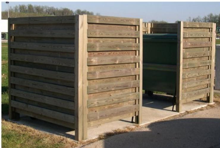
L'avantage d'un système modulaire. Fabrication en pin traité classe IV sans chrome ni arsenic. Version à claire-voie par alternance de planches. Adapté aux conteneurs standards jusqu'à 1000L. Panneaux livrés avec accessoires de scellement. Epaisseur des lattes 2,3 cm.
