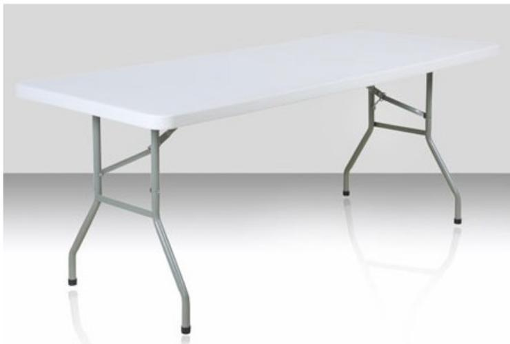
Table pliante économique avec plateau monobloc, réalisé en polyéthylène haute densité, épaisseur : 5 cm. Structure de renfort sous le plateau, encastrement des pieds. Anneau de blocage du piètement en position ouverte. Moulage de renfort aux angles. Traverse métallique de renfort du plateau. Cadre métallique 30 x 15 mm. Finition peinture époxy gris martelé. Piètement pliant tube métallique diamètre 30 mm, peint époxy gris martelé.
