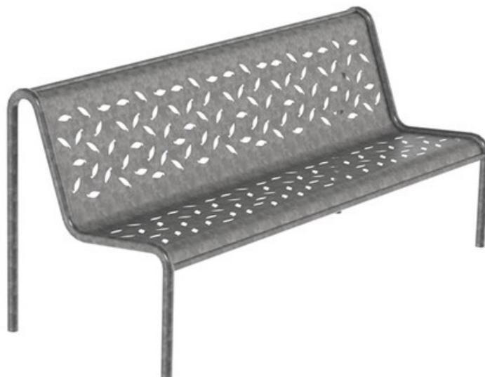
Un banc très moderne qui s'adaptera facilement dans tous les milieux urbains. Assise et dossier en tôle d'acier galvanisé. Tôle découpées au laser avec des dessins de feuilles pour apporter de la modernité. Le perçage des assises et du dossier permet également une évacuation de l'eau en cas de pluie et un séchage plus rapide. Dims (cm) : L 201 X P 75 X H 80,6. Hauteur d'assise : 46,8 cm. Poids : 38,3 kg.
