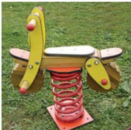
Structure en lamellé collé épaisseur 70 mm, pin du nord haute résistance. Traitement autoclave classe IV. Visserie inox. Eléments de décor en compact 10 mm imputrescible. Surface amortissante 7 m2. Hauteur de chute 53 cm.
