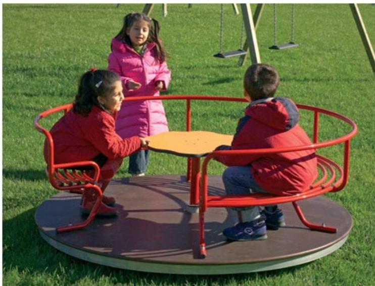
Structure tubulaire en acier verni de section 5 X 3 cm. Plan d'appui en galvanisé avec dossier et sièges. Guidon central de traction. Assemblage avec boulons en acier galvanisé et écrous à blocage automatique. éléments cache écrou en nylon coloré aux normes. Encombrement maximum (cm) : diamètre 190 X H 65. Hauteur de chute : 18 cm. Zone d'implantation diamètre 5,73 m (26 m<sup>2</sup>).
