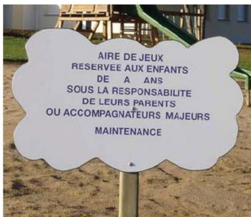
Panneau en compact ép. 10 mm. Texte sérigraphié. Poteau de section 68 X 68 mm en pin du nord traité autoclave classe IV. Hauteur 1,50 m. Visserie inox. A sceller.
