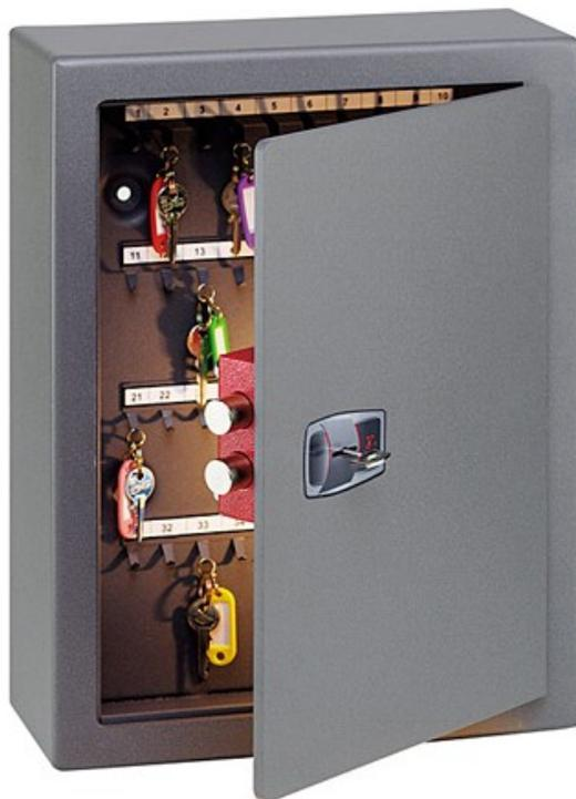
Cadre et porte d'épaisseur 8 mm et corps d'épaisseur 3 mm. Pênes tournants en acier chromé 22 mm. Protection avec plaques d'acier au manganèse au niveau de la serrure. Serrure de haute sécurité certifiée EN 1300 à 8 gorges asymétriques avec clé à double panneton. Clé prisonnière serrure ouverte. Réservation pour mise en place, chevilles fournies avec le coffre. Crochets métalliques. Livrés avec n degrés adhésifs. Capacité : 40 clés. Dims (cm) : L 36 X P 14 X H 47. Volume 20 L. Poids : 25 kg.
