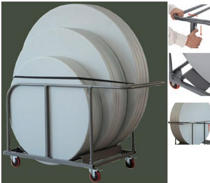
Chariot avec anse extensible 3 positions fabriqué en acier peint par pulvérisation, coloris gris. Large plateau de support pour les tables. Courroie en polyester avec tendeur pour le maintien vertical des tables lorsque le chariot n'est pas entièrement plein. 4 roues en polyuréthane avec frein. Quantité maximum de tables : 15 tables diamètre 122 ou 152 cm, 12 tables diamètre 180 cm. Dims (cm) : L132 à 162 X P83,2 X H102. Poids 34,2 kg.
