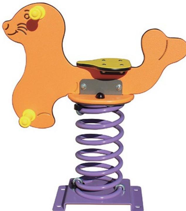
Jeux à ressort pour enfants de 1 à 12 ans, conforme à la norme EN 1176. Hauteur de chute 0,54 m. Espace d'implantation : 300 X 225 cm. Ressort en acier, finition peinture poudre polyester. Forme et assise en HPL, coloré et d'une grande stabilité. Boulonnerie en inox.
