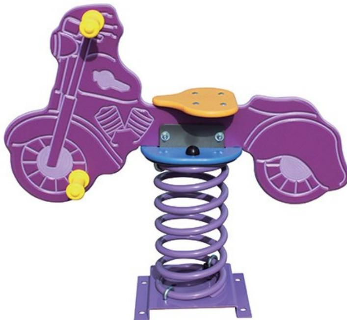
Jeux à ressort pour enfants de 1 à 12 ans, conforme à la norme EN 1176. Hauteur de chute 0,54 m. Espace d'implantation : 300 X 225 cm. Ressort en acier, finition peinture poudre polyester. Forme et assise en HPL, coloré et d'une grande stabilité. Boulonnerie en inox.
