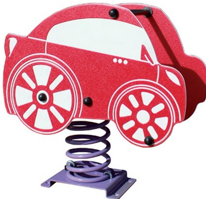
Jeux à ressort pour enfants de 1 à 12 ans, conforme à la norme EN 1176. Hauteur de chute 0,42 m. Espace d'implantation : 269 X 237 cm. Ressort en acier, finition peinture poudre polyester. Forme et assise en polyéthylène, coloré et d'une grande stabilité. Boulonnerie en inox.
