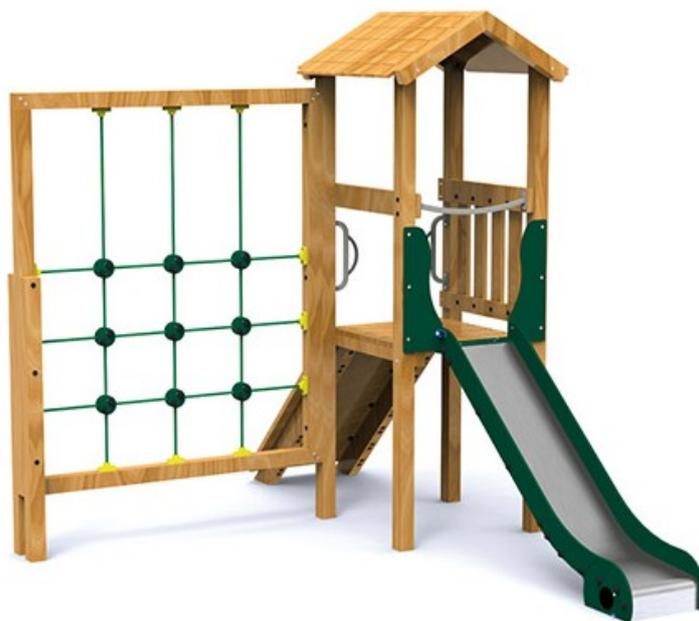
Structure de jeux pour enfants de 3 à 12 ans, conforme à la norme EN 1176. Composée de : 1 tour à 2 étages avec toit à 2 pans, 1 rampe, 1 mur à grimper en corde, 1 toboggan à glissière inox. Hauteur de chute 1,64 m. Espace d'implantation : 730 X 602 cm. Structure en pin sylvestre traité autoclave classe 4 ou stratifié collé multicouches. Panneaux décoratif et toit en HPL, coloré et d'une grande stabilité. Boulonnerie en inox.
