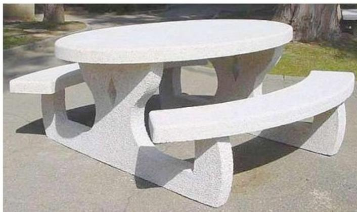
Ultra robuste Réalisée en béton armé désactivé blanc. Granulats : éclats de marbre blanc des Pyrénées. Traitée antigel. Plateau et assise traités anti-tâche et anti-poussière. Montage rapide par emboîtement. A sceller (réservation 4 trous). Epaisseur du plateau et de l'assise : 8 cm. Epaisseur empiètement : 10 cm. Dimension totale (cm) : 180 X 190. Poids 750 kg.
