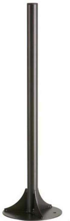
Poteau en acier, finition peinture poudre polyester coloris gris manganèse pour support de sac Nice. Socle rond et renforts en acier electro-zingué épaisseur 4 mm. Fixation au sol 3 points. Dims (cm) : H 98 X Diamètre 28. Poids 5,2 kg.
