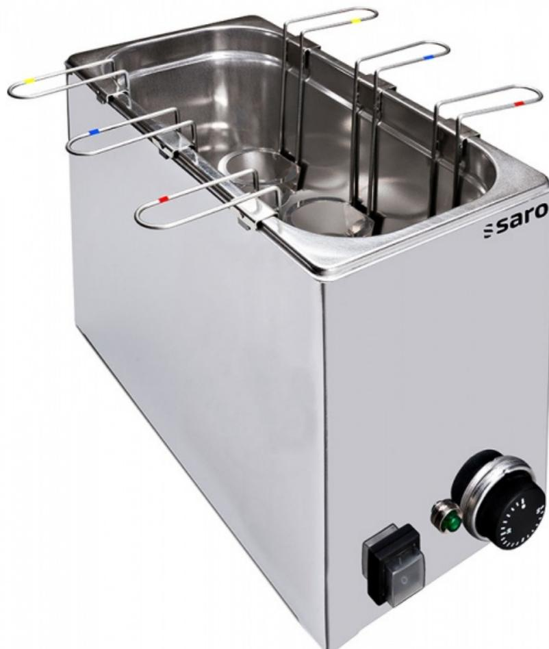
Cuiseur à œufs professionnel pour 6 œufs. Fabriqué en inox. Thermostat réglable. Interrupteur marche/arrêt. Marquage de couleur sur chaque support œuf. Plage de température : 0 à +90°C. Raccordement : 230 V - 50 Hz. Puissance 1,05 kW. Dims (cm) : L 31 X P 34 X H 29. Poids : 6,1 kg.
