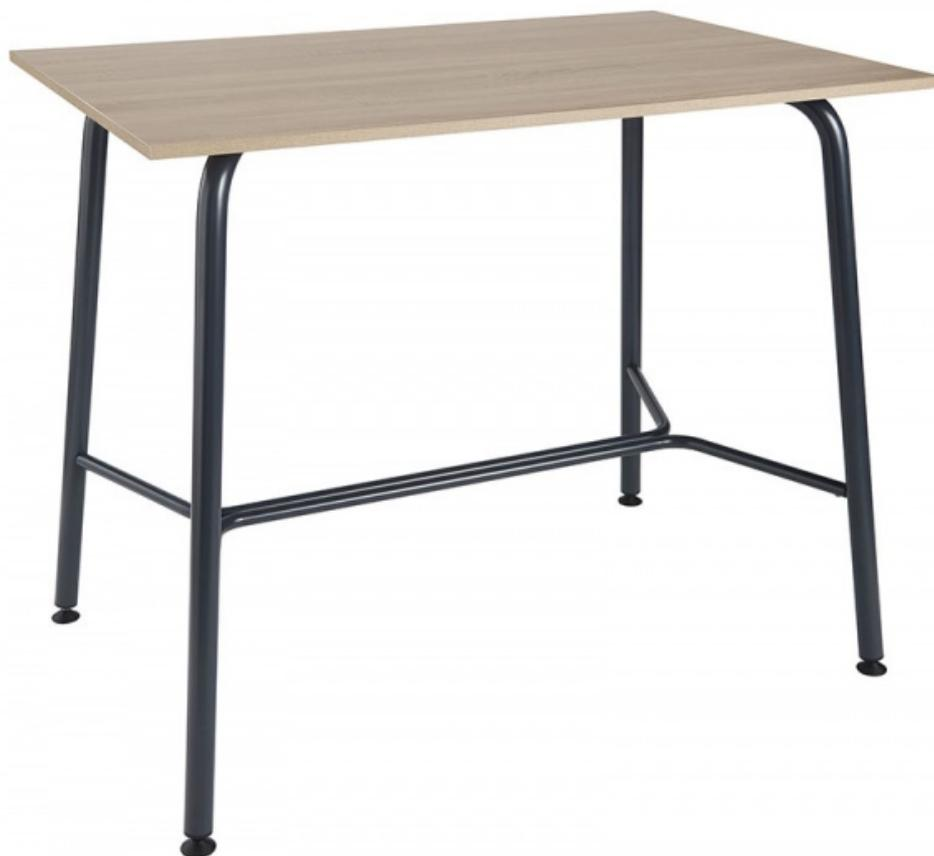
Une gamme de mobilier de restauration moderne, spécialement conçue pour vos salles de restaurants collectifs. Structure sous plateau en tube d'acier 40 X 20 X 1,5 mm. Pieds ronds en acier Ø 40 mm. Vérins de réglage en polypropylène non tachant Ø 50 mm. Plateau stratifié sur les 2 faces, chants alaisés, ép. 21 mm. Autres types de plateaux, nous consulter : mélaminé, médium, compact, stop'son... Nombreux coloris au choix de piétements et plateaux. Manges debout H 110 cm.
