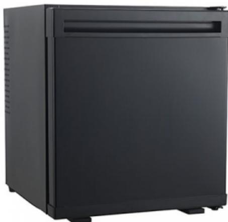
Des minibars nouvelle génération, totalement silencieux (Classe A). Système thermoélectrique. Design sobre et moderne et format optimisé pour s'adapter partout. Porte réversible (droite ou gauche). Finition noire. Eclairage intérieur LED. Alimentation 220-240 V. Classe énergétique F. Faible consommation d'énergie : 90 kWh/a. Dims (cm) : L40 x P42 x H45. Poids : 12 kg. Volume : 28 L. Autre volumes disponibles, nous consulter : 28, 30, 35 et 40 L.
