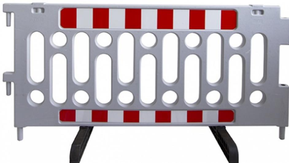
Des barrières police légères et stables, assemblables. Fabriquées en polypropylène avec adhésif réfléchissant classe 1. Coloris gris. Barrières équipées de pieds mobiles et rotatifs pour un stockage à plat. Ne craignent pas la rouille. Assemblage facile grâce au système de connexion. Dims (cm) : L 208 X H 101,5. Poids : 20,6 kg. En option, nous consulter : base de 25 kg, accessoires solaires.
