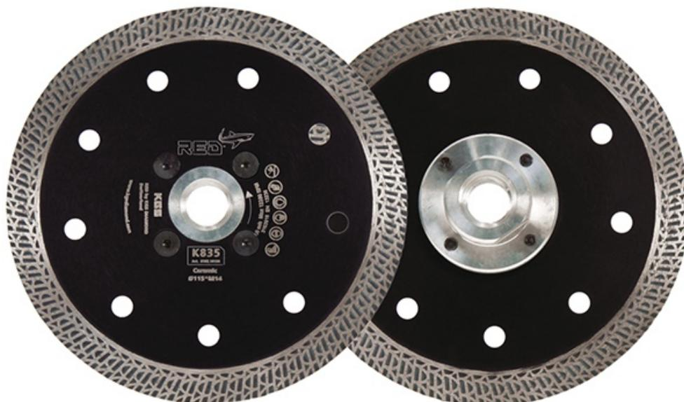
Disques professionnels pour la découpe à sec de différentes pierres (Granit, béton, Dekton, Marbre et céramique). Disponible en diamètres 115 mm, 125 mm et 230mm. Les disques sont disponibles avec un alésage de 22,23mm, et le diamètre 115mm avec une attache M14 pour un changement rapide. Utilisation possible en travaux sur le carrelage, le Dekton et la découpe de plans de cuisine.
