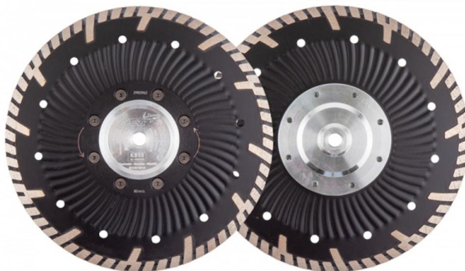
Disque de découpe à sec professionnels en acier ondulé. Disponible en diamètres 115 mm, 125 mm, 150 mm et 230 mm. Les disques sont disponibles avec un alésage de 22,23mm ou une flasque M14 pour un changement rapide. Ces disques permettent une découpe nette de béton, de marbre, du granit, du Terrazzo ou de la pierre artificielle en général. Peut servir pour la découpe de béton sur la voirie.
