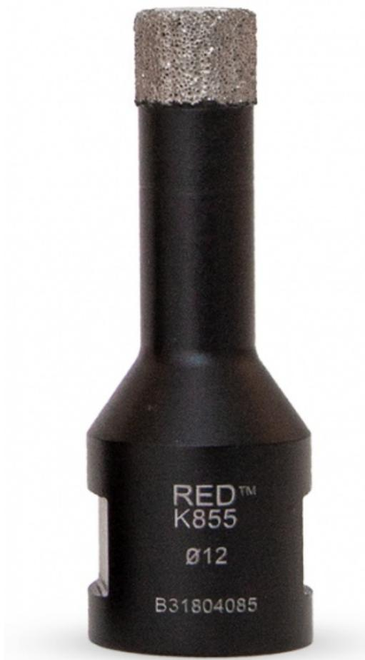
Forets diamantés professionnels pour le perçage à sec de la céramique, la pierre naturelle et artificielle. Diamètres possibles : 6, 8, 10, 12, 27, 35 et 68 mm. Usages : encastrement de boîtiers électriques dans les murs pour les diamètres 68 mm, et la préparation des arrivées de gaz pour les diamètres 10 et 12 mm.
