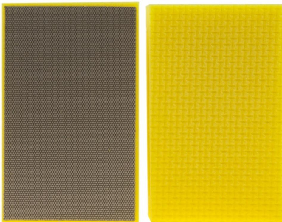
Blocs de ponçage à sec ou à eau, disponibles en dimension 90x55 mm . Plus le grain est grossier plus il enlève de la matière. Les grains 60 et 120 seront dédiés à l'enlèvement important de matière, les grains 200 et 400 au ponçage et les grains suivants au polissage fin des matériaux. Ces blocs permettent un ponçage manuel des bords de carrelage et autres matériaux et le ponçage des zones difficiles à atteindre avec une machine.
