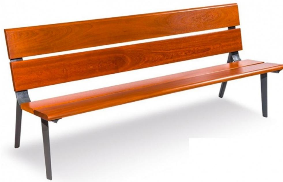
Un banc moderne, avec assise et dossier en bois de Guinée et piètement en fonte. Lattes larges en bois de Guinée, fongicide et vernis hydrofuge. Piètement en fonte gris de type 20. Finition couche anti oxydante et peinture noire oxyron. Visserie en acier galvanisé à chaud. Livré monté. Dims (cm) : L 200 X P 63,7 X H 83,2. Assise H 45,3 cm. Poids : 69,44 kg.
