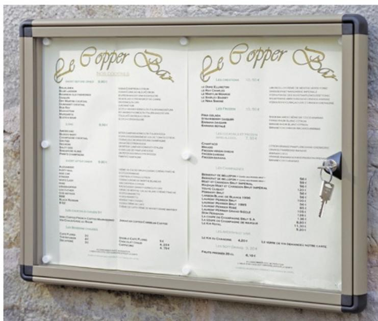
Ouvrant en méthacrylate 3 mm posé siliconé avec encadrement aluminium laqué. Charnière profilée. Fond en tôle laquée encadré par profils laqués. Joint d'étanchéité en EPDM cellulaire. épaisseur hors tout 33 mm. Dimensions H 35cm x L 47cm épaisseur utile 16 mm. Serrure de sécurité traversant le plexi. Coloris standards : sable RAL 1019, gris RAL 7005, rouge RAL 3011, bleu RAL 5000, alu anodisé. Tous coloris possibles dans la gamme RAL avec plus value de 10 .
