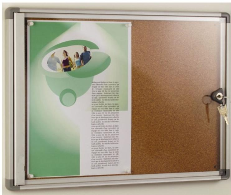
Des prestations rares à ce niveau de prix Encadrement aluminium anodisé naturel 5 microns m. Coins en ABS gris RAL 7046. Ouvrant en plexi de 3 mm. Fond tôle laquée grise ou fond liège (contreplaqué de 5 mm + liège naturel de 1 mm). Serrure de sécurité. épaisseur extérieure 27 mm, épaisseur utile 11,8 mm.
