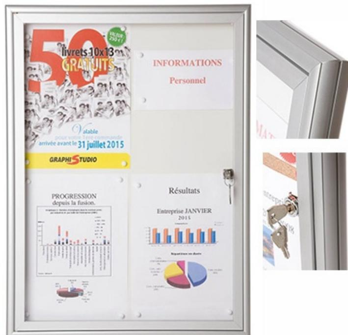
Vitrine d'intérieur avec cadre en aluminium anodisé. Fixation murale aux 4 coins de la tôle. Charnières sur pivot en laiton. Vitrage méthacrylate (version avec verre sécurit 4 mm, nous consulter). Serrure dans le vitrage. Fond tôle blanche laquée (modèle avec fond liège, nous consulter). Epaisseur hors tout 32 mm, utile 22 mm. Porte encastrée dans le fond de la vitrine. Porte battante. Modèle 16 A4. Dims (cm) hors tout : L89,4 x P3,2 x H124,2.
