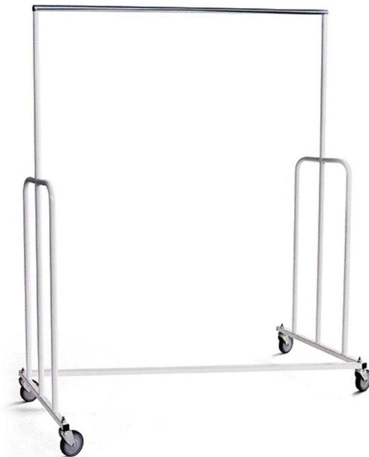
Chariot penderie emboitable, socle en Z. Structure en tube d'acier, finition peinture époxy blanc. Barre penderie en tube rond d'acier électrozingué. Deux poignées de chaque côté facilitent la manutention tout en servant de renforts aux montants. Mobilité assurée par 4 roulettes pivotantes à œil diamètre 100 mm, bandage caoutchouc synthétique. Charge utile : 110 kg. Dims (cm) : L149,5 x P61 x H176,1. Poids : 18 kg.
