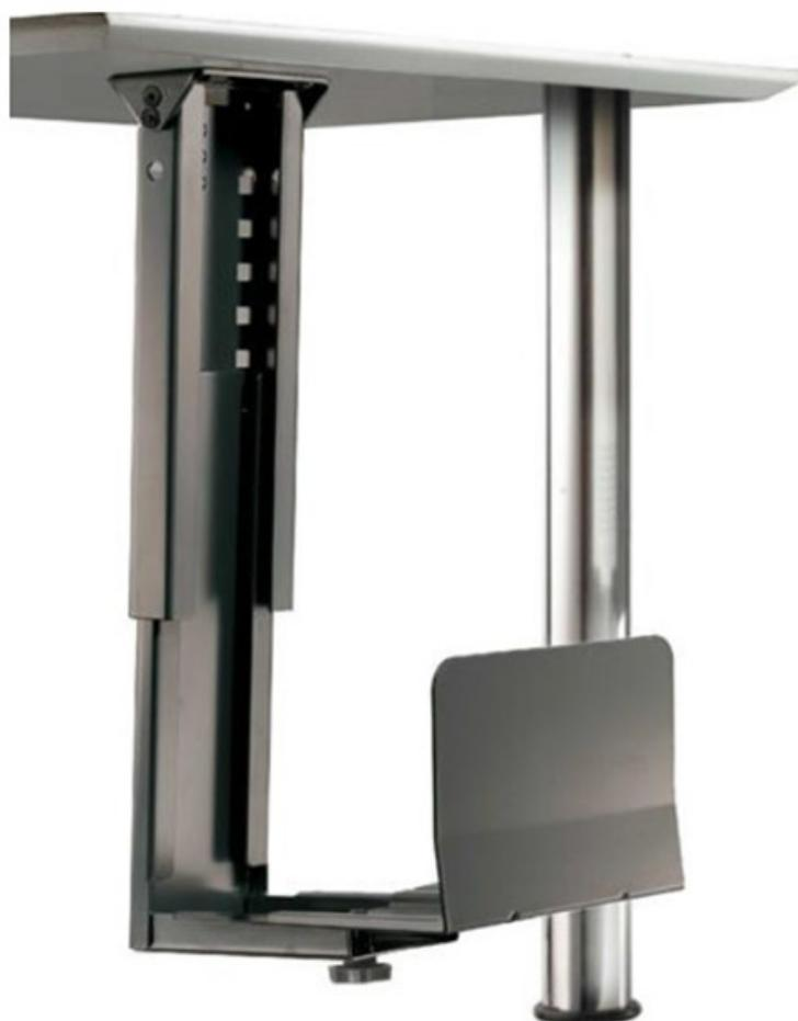
Un support UC réglable en hauteur et largeur qui s'adapte à tous les postes informatiques ! Structure mécano-soudée en acier. Finition peinture époxy. Deux coloris au choix : noir ou gris argent. Réglage de la hauteur par crémaillère et de la largeur par molette de blocage. Un fixateur sous le plateau. Charge utile jusqu'à 30 kg. Dimensions (cm) : L 13,4 à 23,4 x H 39 à 54. Poids : 4,2 kg.
