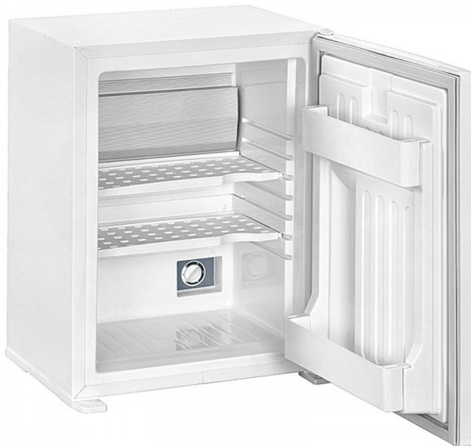
Des minibars silencieux grâce au système Peltier. Equipés de thermostat régulateur de température. Eclairage intérieur par LED. Intérieur avec 2 plateaux réglables. Puissance 63 W. Tension 220-240 V, 50-60 Hz. Consommation électrique : 60 KWH/an. Température moyenne : 8 à 15°C. Porte pleine. Coloris : blanc. Nouvelle classe énergétique E.Dims (cm) : L 38,5 X P 38,5 X H 48,5. Poids : 12,3 kg.
