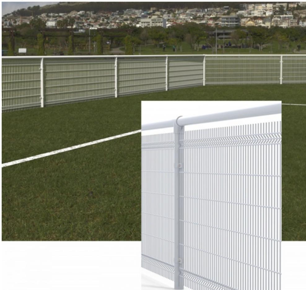
Courante principale pour grille, entrée 2,5m. Tube en acier galvanisé plastifié. Raccord monobloc en aluminium plastifié. Main-courante avec grille en partie basse double fil, maille 200x50mm. Grille fixée par 2 colliers courts à chaque poteau. Hauteur hors sol : 1,1m. Entrée des poteaux : 2,5m. Forme et dimension du profil : Rond Ø 60mm. Matériau : Acier renforcé. Couleur : Plastifié blanc. Option : portail, collier long.
