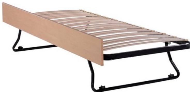
Cadre métallique en tube 40x27 mm cintré sur chant. Embouts doubles en PVC clipsés. 24 doubles lattes multiplis (hêtre ou bouleau) largeur 38 mm épaisseur 8 mm. Pieds métalliques en tubes diamètre 25 mm escamotables par ressorts. Roulettes diamètre 50 mm montés sur les pieds. Façade en mélaminé ép. 19 mm chants ABS 2 mm. Finition epoxy gris anthracite. Mélaminé.
