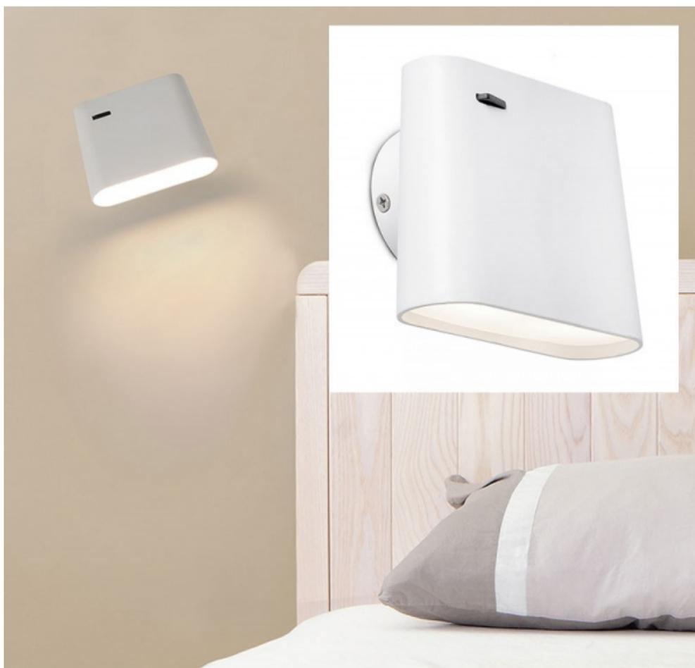
Une lampe design, une applique LED orientable aux formes simples mais intemporelles. La source d'éclairage est SMD LED 6W 2700K 230Lm CRI>80 avec driver inclus. Cette applique moderne se démarque par sa grande fonctionnalité. Fabriquée en aluminium et acier, coloris blanc. Tension 100-240 V. IP 20. Classe I. Dims (cm) : L 12 X P 7 X H 9,5.
