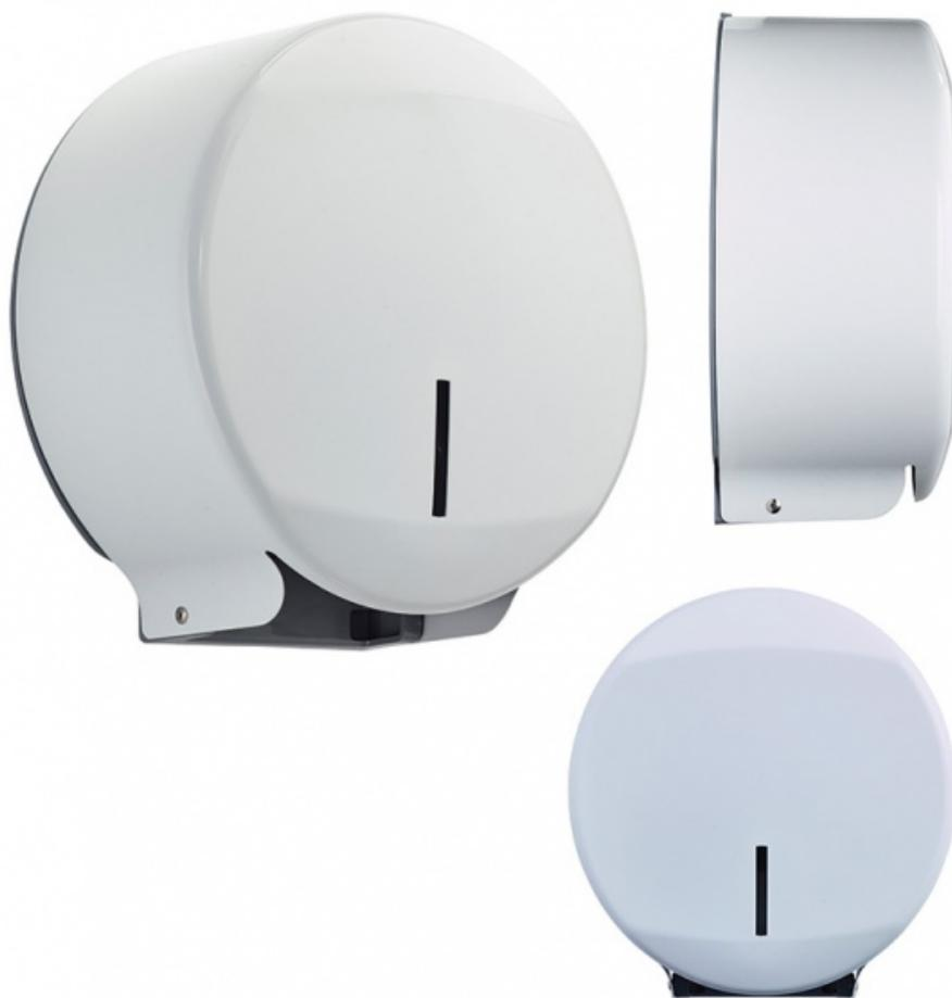
Des distributeurs robustes et design fabriqués en inox AISI 304 18/10ème. Large fenêtre de contrôle des consommables. Système antivol avec serrure à clé. Ouverture frontale facilitant le changement de consommable. Accepte les bobines format 200 m. Mandrin Ø 45 mm. Coloris blanc RAL 9016. Dims (cm) : diamètre 27,5 x H12,5.
