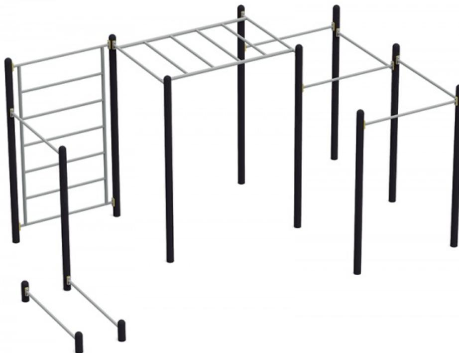
Un circuit sportif pour l'extérieur, idéal pour favoriser la pratique régulière du sport. Conforme à la norme EN 16630. Ensemble fabriqué en acier galvanisé, finition peinture poudre. Poteaux Ø 89 mm. Barres Ø 33 mm. Exige un sol qui amortit les impacts selon la norme EN 1176. Hauteur de chute : 241 cm. Zone d'implantation : 8,23 x 5,88 m. Surface de sécurité : 46,47 m<sup>2</sup>.
