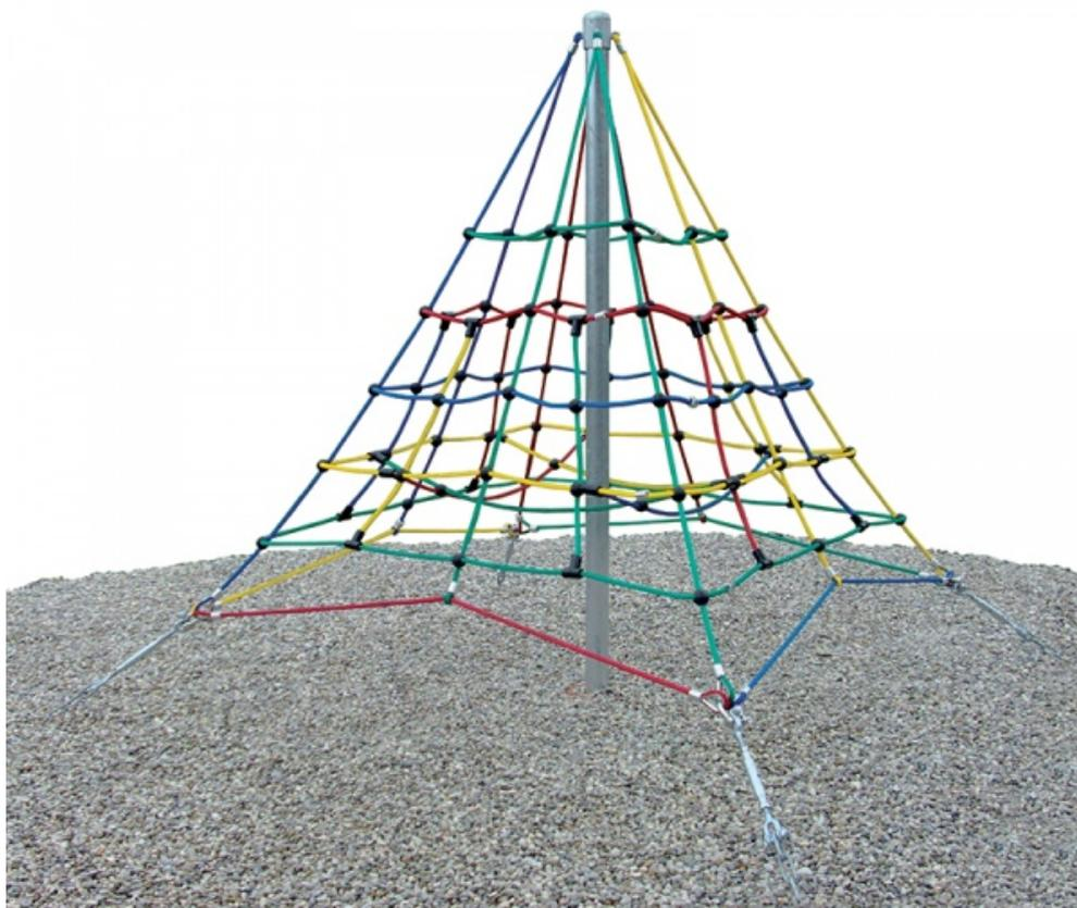
Jeu pour enfants de 3 à 12 ans. Conforme à la norme EN 1176. Une pyramide d'escalade moderne avec des matériaux demandant peu d'entretien. Éléments de fabrication : acier renforcé, corde en polyester. Structure à sceller. Hauteur de chute : 0,95 m. Surface d'implantation : diamètre 6,8 m. Surface de sécurité : 36,1 m<sup>2</sup>.
