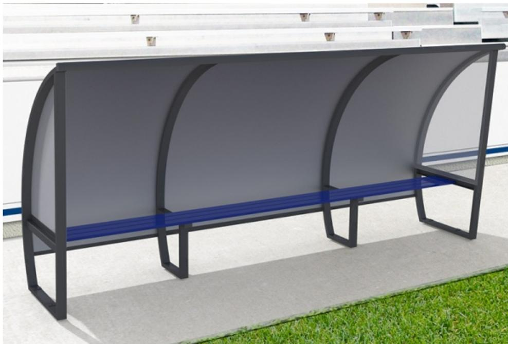
Abris de touche avec structure aluminium plastifié. Ossature principale en 60 X 30 X 2 mm. L'assise se compose de 3 lisses en tube d'aluminium section 20 X 80 X 2,5 mm. Profil arrondi en partie haute. Les cotés sont dotés de protections transparentes résistantes aux impacts de ballons en polycarbonate 2 mm. Protection arrière en aluminium composite 3 mm. Embouts de protection en PVC. Dims (cm) pour 5 joueurs : L250 X P150 X H200. Autres longueurs, nous consulter.
